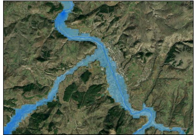
Фигура 2. Моделирана дълбочина на водния слой.
